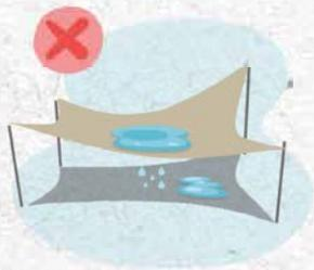
Un cattivo tensionamento crea **sacche di acqua** che possono danneggiare la vela e l'installazione.
