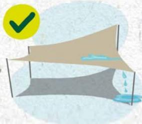
Installa la tenda con un'**inclinazione del 25-30%** per garantire una corretta evacuazione dell'acqua.
