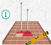
1 Pulisci la superficie e assicurati che essa abbia la pendenza necessaria per drenare.
